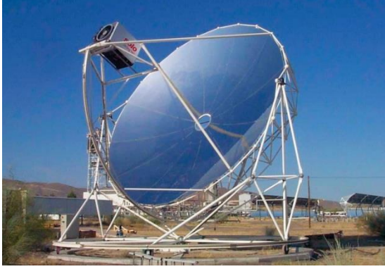
الشكل (5-6) مجمع شمسي قطعي مركز بنسبة تركيز C = 200
